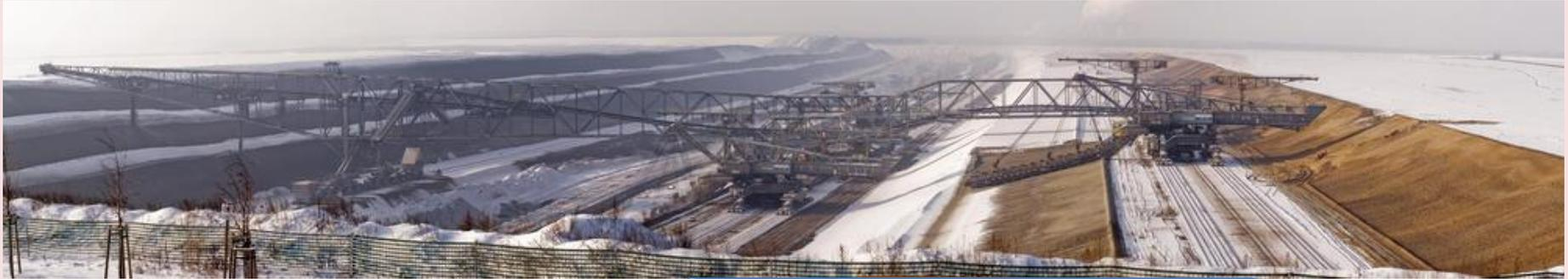
Abbau beginnt mit Entfernung und Ablagerung des Deckgebirges
